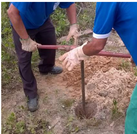
Figura 9-40. Perfuração de sondagem a trado manual.
