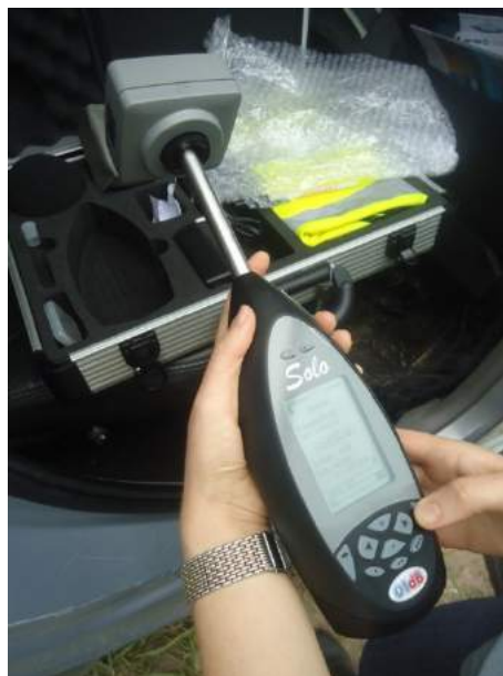
Figura 9-19. Calibração do medidor de nível de pressão sonora.
