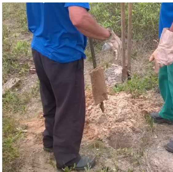
Figura 9-41. Retirada do material oriundo da sondagem.
