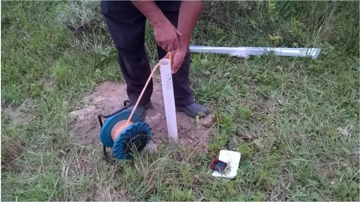
Figura 9-44. Medição do nível do aquífero freático no PM-03.
