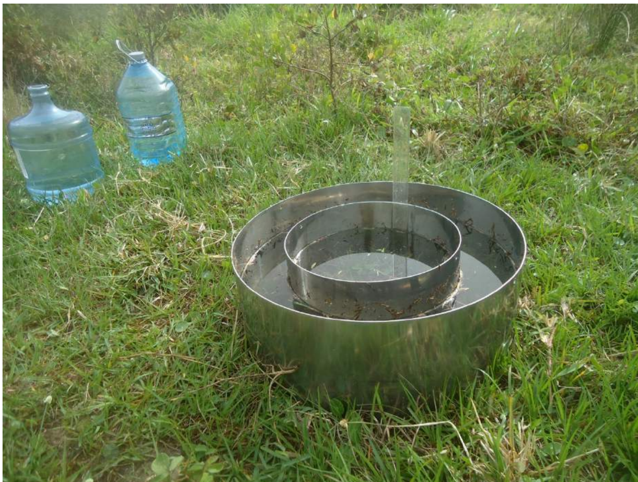
Figura 9-32 - Leitura da lâmina de infiltração da água no solo.
